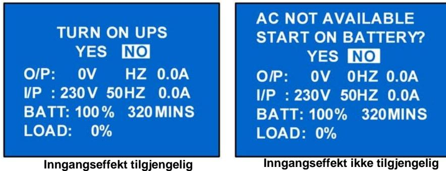
For å slå på UPS-enheten, trykk på piltasten Opp eller Ned for å velge JA og trykk deretter på Enter. UPS-enheten starter opp, LCD-skjermen viser *UPS STARTER* deretter *OPPSTART VELLYKKET* når UPS-enheten har slått seg på, som vist i **Figur 16**.
